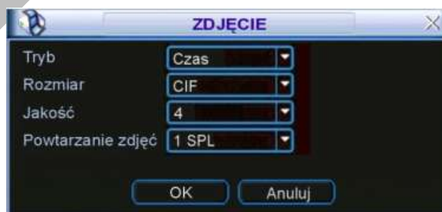
Rys. 4-11a. Ustawianie parametrów zdjęcia w menu Kompresja .
