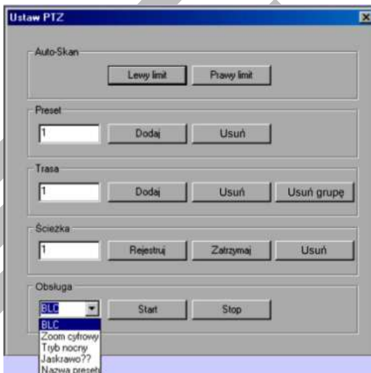
Rys. 7-16. Programowanie parametrów PTZ.
