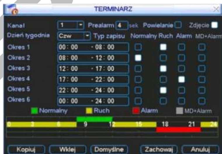
Rys. 4-9d. Ustawianie aktywacji wykonywania zdjęć w menu Terminarz.
