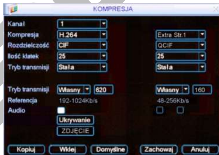
Rys. 4-9a. Przycisk Zdjęcie w menu Kompresja .
