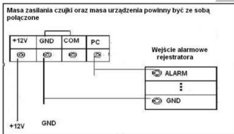
Rys. 3-6. Schemat podłączenia czujek do wejść alarmowych.
