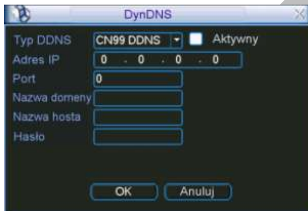
Rys. 5-13. Ustawianie Dynamic DNS.
