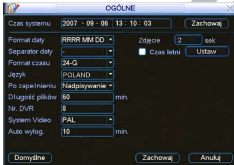
Rys. 4-9c. Ustawianie parametru czas zdjęcia w menu Ogólne.
