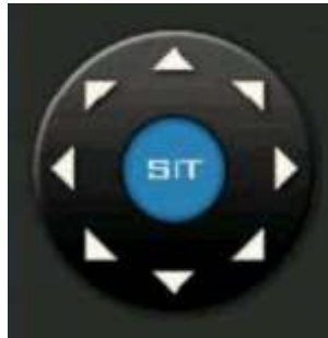
Rys. 4-22. Przycisk wielokierunkowy sterowania głowicą PTZ.
