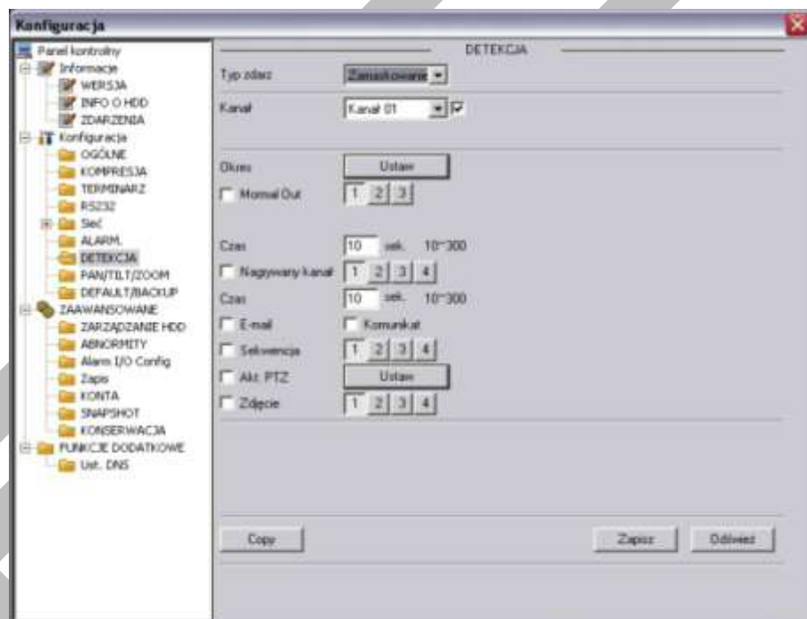
Rys. 7-42a. Panel kontrolny → Konfiguracja → Detekcja → Zamaskowanie kamery.
