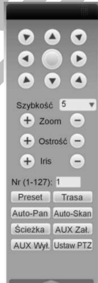
Rys. 7-14. Pełny interfejs sterowania PTZ
