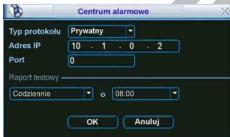
Rys. 5-17. Ustawianie serwera alarmowego.
