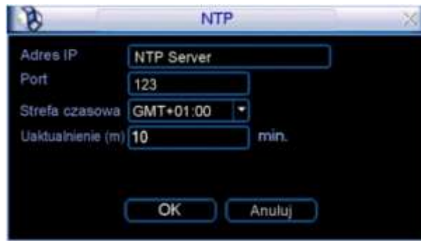
Rys. 5-10. Ustawianie parametrów NTP.
